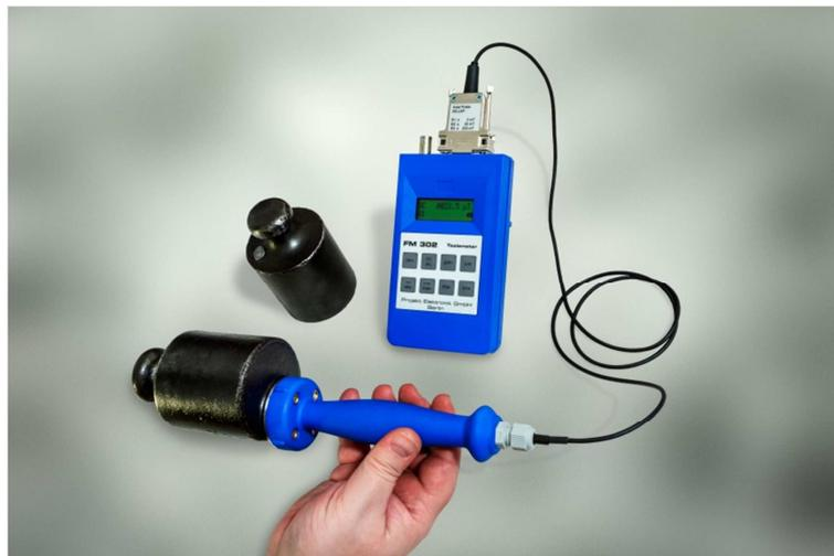
Speziell für diese Messungen haben wir zusammen mit dem Landesamt für Mess- und Eichwesen Berlin-Brandenburg einen Handgriff für die Sonde AS-LAP entwickelt. Der Griff ist an seiner Unterseite mit einer Schutzplatte aus Aluminium versehen.
